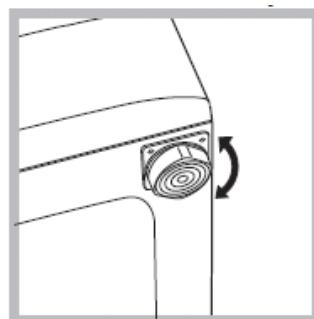
تراز کردن صحیح دستگاه باعث ثبات آن شده و از ارتعاشات و صدای بیش از اندازه جلوگیری کرده و نمی‌گذارد دستگاه در حین کار به اطراف حرکت کند. در صورتی که ماشین را روی فرش یا موکت قرار می‌دهید، پایه‌های آن را طوری تنظیم نمایید که فضای تهویه کافی در زیر دستگاه وجود داشته باشد.
