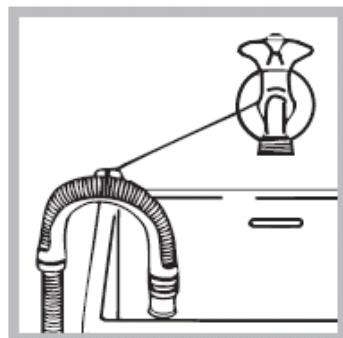
! استفاده از شیلنگ‌های اضافی و رابط تومیه نمی‌شود. اگر واقعاً ضرورت دارد قطر شیلنگ اضافی باید دقیقاً برابر شیلنگ اصلی بوده و طول آن نباید از ۱۵۰ سانتیمتر بیشتر باشد.
