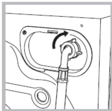
۳ - بررسی نمایید که شیلنگ ورودی آب خم یا تا نشده باشد.
