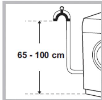
می‌توانید شیلنگ تخلیه را در داخل سینک، دستشویی یا وان بگذارید و آن را با وسیله عرضه شده با شیلنگ تخلیه محکم کنید (تصویر را ملاحظه نمایید). انتهای شیلنگ تخلیه نباید به هنگام تخلیه درون آب قرار گیرد.
