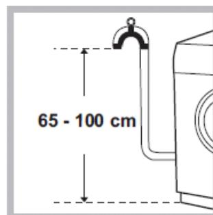
یا این که می‌توانید آن را لبه سینک، دستشویی یا وان بگذارید و آن را با وسیله عرضه شده با شیلنگ تخلیه محکم کنید (تصویر را ملاحظه نمایید). سر آزاد شیلنگ نباید به هنگام تخلیه زیر آب قرار گیرد.
