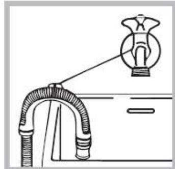
! استفاده از شیلنگ‌های اضافی و رابط توصیه نمی‌شود. اگر واقعاً ضرورت دارد قطر شیلنگ اضافی باید دقیقاً برابر شیلنگ اصلی بوده و طول آن نباید از ۱۵۰ سانتیمتر بیشتر باشد.
