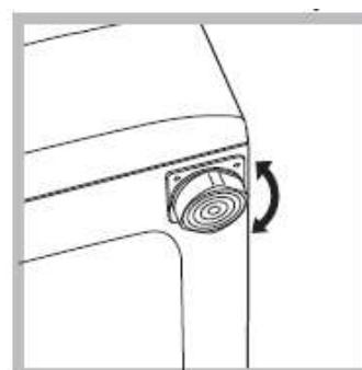
تراز کردن صحیح دستگاه باعث می شود تا دستگاه در حین کار به حد کافی ثابت بوده و از لرزش و تولید صدای بیش از اندازه جلوگیری شود و اجازه حرکت دستگاه را در حین کار به اطراف نمی دهد. اگر دستگاه را روی فرش یا موکت قرار می دهید، پایه های آن را طوری تنظیم نمایید که فضای تهویه کافی در زیر دستگاه وجود داشته باشد.
