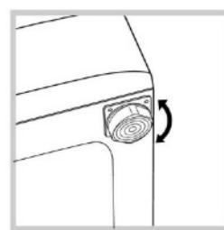
۲- اگر سطح زیر دستگاه کاملاً مساو نباشد می توانید با چرخاندن پایه های جلو دستگاه، (با توجه به شکل) آن را تراز نمایید توجه داشته باشید که دستگاه باید تا حدی تراز شود که زاویه آن از ۲ درجه
