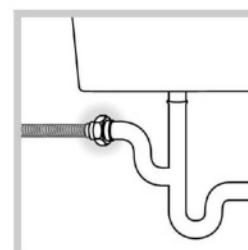
شنگ تخلیه ممکن است به انشعاب زیر سینک متصل شود. قبل از اتصال اطمینان حاصل کنید که اتصالات از هم جدا نشده و مسیر آن باز باشد.
