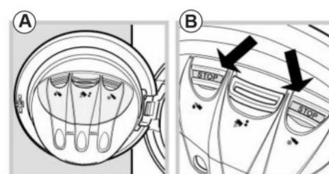
1. درب را باز کنید تا کشوی جا پودری قابل دسترسی باشد (شکل A)
