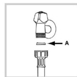
۲- قبل از نصب دستگاه، شیر آب سرد را بازکنید تا رسوبهای احتمالی داخل لوله آب از آن خارج شده و آب شفاف جریان یابد؛ سپس با توجه به شکل، واشر آب بندی را داخل انتهای شلنگ قرار داده و بوسیله پیچاندن به شیر آب سرد (با رزو ۳/۴ گاز) وصل کنید.
