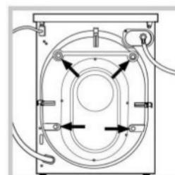
۳- چهار عدد پیچ محافظ و واشر لاستیکی و فضا پرکن های مربوطه را که در قسمت پشت دستگاه قرار دارند (با توجه به شکل) باز کنید.
