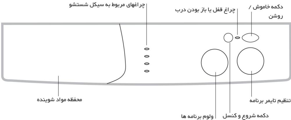
**چراغ نشانگر قفل درب / خاموش - روشن :** روشن شدن این چراغ نشان دهنده آن است که درب قفل شده است تا از باز شدن تصادفی ان جلوگیری به عمل آید. برای اینکه از آسیب رسیدن به دستگاه جلوگیری گردد، پس از پایان چرخه شستشو و پیش از آنکه درب را باز کنید کمی سبیر کنید تا چراغ شروع به چشم زدن کند. (زمان انتظار حدود ۲ دقیقه می باشد.)
