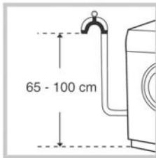
شنلگ خروجی فاضلاب دستگاه را بدون اینکه خم شود به فاضلاب یا لوله فاضلاب داخل دیوار که از کف زمین ۶۵ تا ۱۰۰ سانتیمتر فاصله دارد وصل کنید .
