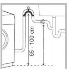
شیلنگ تخلیه ممکن است به سیفون زیر کاسه دستشویی متصل گردد . قبل از اتصال شیلنگ تخلیه دستگاه اطمینان حاصل کنید هیچگونه مانع یا درپوشی در محل اتصال شیلنگ تخلیه و سیفون وجود نداشته باشد ارتفاع شیلنگ تخلیه باید از ارتفاع دهانه ورودی سیفون بیشتر بوده تا امكان ورود آب از سیفون به دستگاه وجود نداشته باشد .
