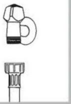
۱- لوله تغذیه را با استفاده از یک اتصال رزوه دار  $\frac{3}{4}$  گازی به شیر آب سرد وصل کنید.
