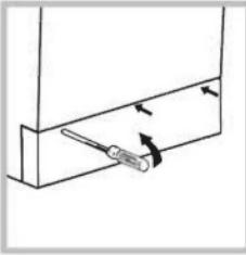
۱- با استفاده از یک پیچ گوشتی ، صفحه رویی بخش جلو و پایین ماشین لباسشویی را بردارید (با توجه به شکل)
