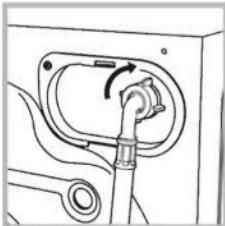
۲- شیلنگ ورودی را به ورودی آب متناظر روی ماشین لباسشویی که در بالا سمت راست پشت دستگاه قرارداده وصل کنید. (شکل را ببینید)
