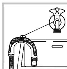
یا این که می توانید آن را در داخل سینک یا وان بگذارید، دقت کنید که شیلنگ تخلیه را باید بواسیله شیر آب مهار کنید (شکل مقابل). سر آزاد شیلنگ نباید به هنگام تخلیه زیر آب قرار گیرد.
