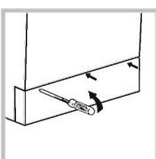
۱- با استفاده از یک پیچ گوشتنی تخت، روکش جلویی واقع در قسمت جلو و پایین دستگاه را باز کنید (با توجه به شکل).
