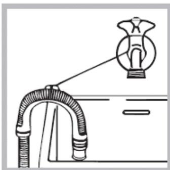
! استفاده از شیلنگ‌های اضافی و رابط توصیه نمی‌شود. اگر واقعاً ضرورت دارد قطر شیلنگ اضافی باید دقیقاً برابر شیلنگ اصلی بوده و طول آن نباید از ۱۵۰ سانتیمتر بیشتر باشد.
