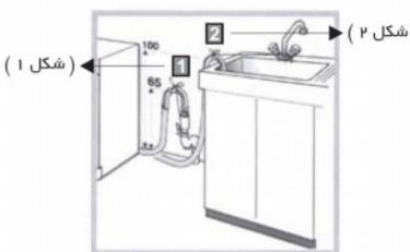
شلنگ خروجی پس‌آب (فاضلاب) دستگاه را بدون اینکه خم شود به فاضلاب یا لوله فاضلاب داخل دیوار که از کف زمین ۶۵ تا ۱۵۰ سانتی متر فاصله دارد وصل کنید.
