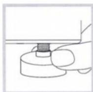
تراز دستگاه به طور صحیح باعث ثبات دستگاه شده و از هر گونه لرزش ، سر و صدا و جابجایی در طول کار آن جلوگیری به عمل خواهد آورد.
