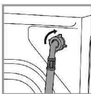
این عمل با پیچاندن انتهای شلنگ به مدخل روغنی آب سرد دستگاه در قسمت پشت دستگاه و در گوشه بالای سمت راست دستگاه انجام می شود.
