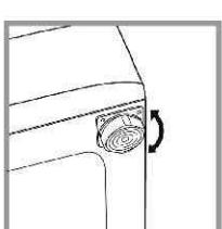
**۲ - اگر سطح زیر دستگاه کاملاً صاف نباشد می توانید با باز یا سفت کردن پایه های جلو دستگاه (با توجه به شکل) آن را تراز نمایید توجه داشته باشید که دستگاه باشید که دستگاه باید تا حدی**
