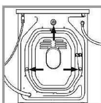
**۳ - چهار عدد پیچ محافظ و واشر لاستیکی و فضایپرکن های مربوطه را که در قسمت پشت دستگاه قرار دارند (با توجه به شکل) باز کنید.**
