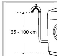
شیلنگ تخلیه را بدون این که آن را خم نمایید، به لوله فاضلاب دیواری به ارتفاعی بین ۶۵ تا ۱۰۰ سانتیمتری کف قرار دارد وصل کنید.
