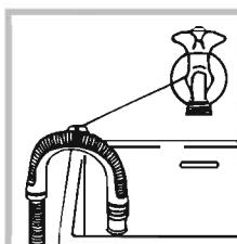
یا این که می توانید آن را در داخل سینک یا وان بگذارید، دقت کنید که شیلنگ تخلیه را باید بوسیله شیر آب مهار کنید (شکل مقابل). سر آزاد شیلنگ نباید به هنگام تخلیه زیر آب قرار گیرد.
