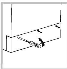
۱- با استفاده از یک پیچ گوشته تخت، پوشش جلویی واقع در قسمت جلو و پایین دستگاه را باز کنید (با توجه به شکل).
