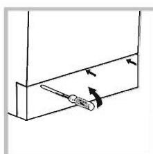
۳- با استفاده از یک پیچ گوشتشی، پوشش صفحه پایینی جلوی دستگاه را بردارید.
