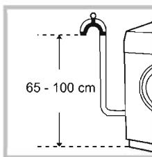
شیلنگ تخلیه را بدون این که آن را خم نمایید، به لوله فاضلاب دیواری که در ارتفاعی بین ۶۵ تا ۱۰۰ سانتیمتری کف قرار دارد وصل کنید.
