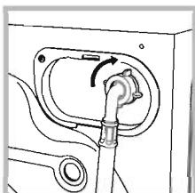
۲- شیلنگ ورودی آب را به مدخل ورودی آب سرد که در قسمت بالا سمت راست پشت دستگاه قرار دارد وصل کنید (شکل را ببینید).
