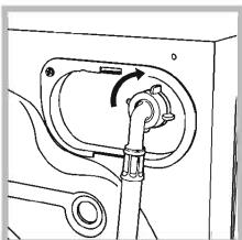
۲- شیلنگ ورودی آب را به مدخل ورودی آب سرد که در قسمت بالا سمت راست، پشت دستگاه قرار دارد وصل کنید(طابق تصویر).
