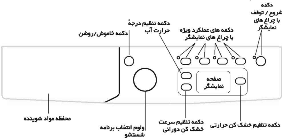
**دکمه تنظیم درجه حرارت آب** : جهت کاهش یا تنظیم دما مورد استفاده می باشد. به هنگام تنظیم، درجه حرارت انتخاب شده روی صفحه نمایشگر نشان داده می شود.
