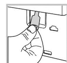
۳- با استفاده از یک پیچ گوشتشی، پوشش صفحه پایین جلوی دستگاه را بردارید.
