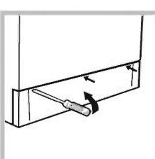
۱- با استفاده از یک پیچ گوشی تخت، پوشش جلویی واقع در قسمت جلو و پایین دستگاه را باز کنید (با توجه به شکل).
