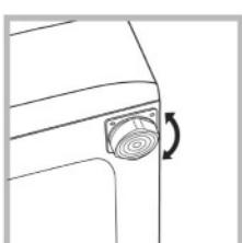
۲- اگر سطح زمین، صاف و تراز نباشد می توانید با باز و بسته کردن پایه های قابل تنظیم دستگاه که در جلوی آن قرار دارد تراز کنید. (با توجه به شکل)
