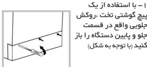
۱- با استفاده از یک پیچ گوشتنی تخت، روکش جلویی واقع در قسمت جلو و پایین دستگاه را باز کنید (با توجه به شکل)
