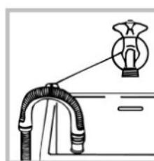
استفاده از شیلنگ های اضافی و رابط توصیه نمی شود، اگر واقعاً ضرورت دارد، قطر شیلنگ اضافی باید دقیقاً برابر شیلنگ اصلی بوده و طول آن نباید از ۱۵۰ سانتیمتر بیشتر باشد.
