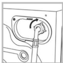
۲- شیلنگ ورودی آب را به مدخل ورودی آب سرد که در بالا سمت راست پشت دستگاه قرار دارد وصل کنید. (شکل را ببینید)
