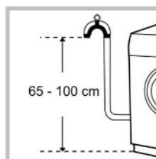
یا این که می توانید آن را در داخل سینک یا وان بگذارید، دقت کنید که شیلنگ تخلیه را باید بوسیله شیر آب مهار کنید. (شکل مقابل) سر آزاد شیلنگ نباید به هنگام تخلیه زیر آب قرار گیرد.
