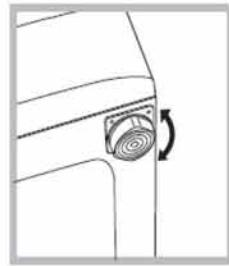
تراز کردن صحیح دستگاه باعث ثبات آن شده و از ارتعاش و صدای بیش از اندازه جلوگیری کرده و نمی‌گذارد که دستگاه در حین کار به اطراف حرکت کند. در صورتی که ماشین را روی فرش یا موکت قرار می‌دهید، پایه‌های آن را طوری تنظیم کنید که فضای تهویه کافی در زیر ماشین لباسشویی وجود داشته باشد.
