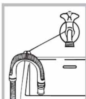
استفاده از شیلنگ‌های اضافی و رابط توصیه نمی‌شود؛ اگر واقعاً ضرورت دارد قطر شیلنگ اضافی باید
