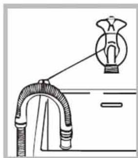
! استفاده از شیلنگ‌های اضافی و رابط توصیه نمی‌شود؛ اگر واقعاً ضرورت دارد قطر شیلنگ اضافی باید دقیقاً برابر قطر شیلنگ اصلی بوده و طول آن نباید از ۱۵۰ سانتی‌متر بیشتر باشد.
