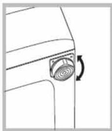
تراز کردن صحیح دستگاہ باعث ثبات آن شده و از ارتعاش و صدای بیش از اندازه جلوگیری کرده و نمی‌گذارد که دستگاہ در حین کار به اطراف حرکت کند. در صورتی که ماشین را روی فرش یا موکت قرار می‌دهید، پایه‌های آن را طوری تنظیم کنید که فضای تهویه کافی در زیر ماشین لباسشویی وجود داشته باشد.
