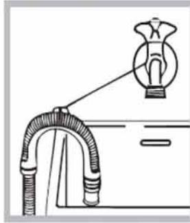
! استفاده از شیلنگ‌های اضافی و رابط توصیه نمی‌شود. اگر واقعاً ضرورت دارد، قطر شیلنگ اضافی باید دقیقاً برابر شیلنگ اصلی بوده و طول آن نباید از ۱۵۰ سانتی‌متر بیشتر باشد.
