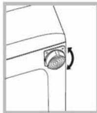
تراز کردن صحیح دستگاه باعث ثبات آن شده و از ارتعاشات و صدای بیش از اندازه جلوگیری کرده و نمی‌گذارد که دستگاه در حین کار به اطراف حرکت کند. در صورتی که ماشین را روی فرش یا موکت قرار می‌دهید، پایه‌های آن را طوری تنظیم کنید که فضای تهویه کافی در زیر ماشین لباسشویی وجود داشته باشد.
