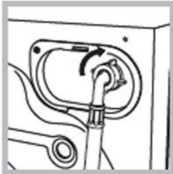
2. شلنگ و رودی را با استفاده از یک اتصال رزوه دار 3/4 گازی به شیر آب سرد وصل کنید (شکل را بینید).
