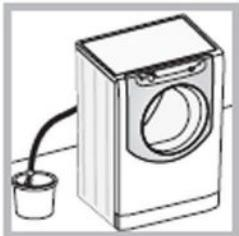
2. مطمئن شوید که سطح آب درون ماشین لباس شوئی پایین تر از در باز شده است؛ اگر چنین نبود، آب اضافی را با شلنگ تخلیه خارج کرده و آنرا مطبق شکل در یک سطل بپریزید.
