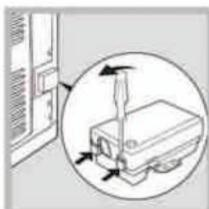
۱. با قراردادن یک پیچ در زبانه های کناری قاب، جعبه تقسیم را باز کنید. از پیچ گوشتشی به عنوان اهرم استفاده کرده و آنرا به پایین فشار دهید تا قاب باز شود
