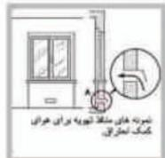
سیستم گردش هوای مناسب داشته باشد، چون هوای احتراق لازم است. جریان هوای لازم برای احتراق باید کمتر از  $\frac{1}{2} \text{ متر مکعب بر ساعت}$  به ازای هر کیلووات توان نصب شده باشد.
