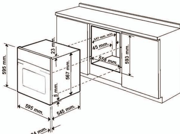
! وسیله بعد از نصب نباید با قطعات الکتریکی تماس پیدا کند. مقدارهای مصرف دستگاه که روی پلاک آن نوشته شده است بر اساس این نوع نصب می باشد.
