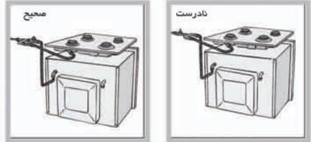
وصل کرده یا برای آنها از یک شیر استفاده کنید. تغذیه دو دستگاه باید جدا از هم بوده و هر کدام باید یک شیر قطع کننده مجزا داشته باشد تا بطور کامل از هم دیگر مستقل گردد.
