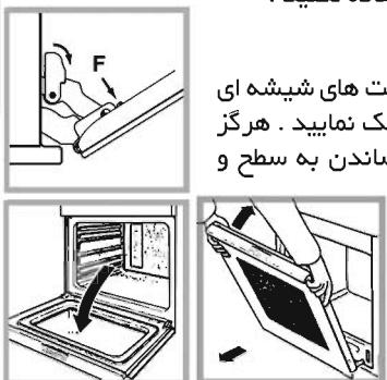
با استفاده از یک اسفنج و مواد تمیز کننده (غیر ساینده) قسمت های شیشه ای دستگاه را تمیز نموده و سپس با یک دستمال نرم آن را خشک نمایید . هرگز از مواد تیز و ساینده استفاده نکنید چون باعث آسیب رساندن به سطح و خدش دار کردن شیشه دستگاه می شود .
